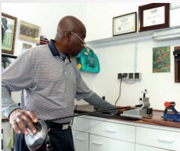
Richard Phillips während der Anpassung der Frequenz, dem „frequency matching“
