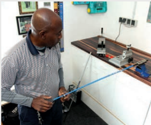
Richard Phillips nimmt eine Rotationsmessung („spinning“) vor.
