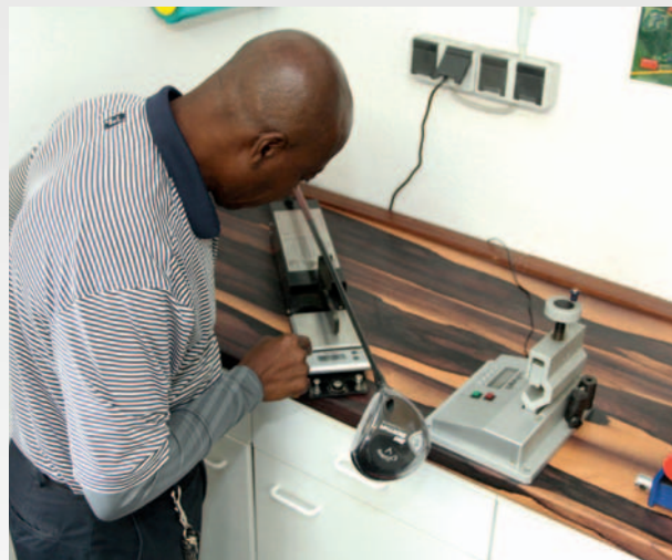
Richard Phillips bei der Anpassung des Schwunggewichts, dem sogenannten „swing weighting“
